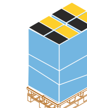
Paletyzacja 4 ćwierćpalet na palecie EUR z automatycznym foliowaniem
